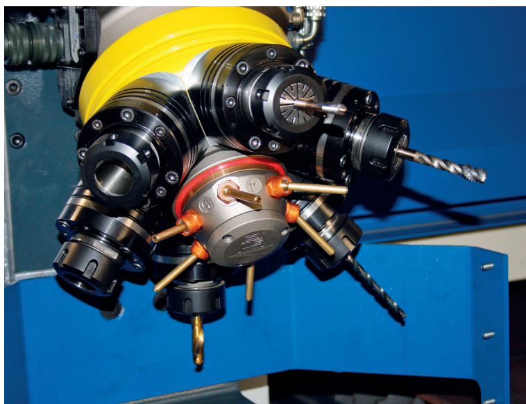
La testa a forare a sei utensili di cui sono datati i sistemi Promotec.
